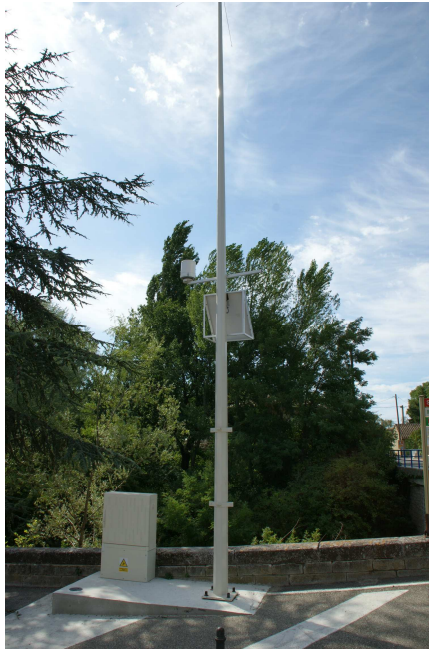
Illustration 18 : Station limnimétrique de Bouchet sur l'Hérein (limnimètre à gauche et pluviomètre à droite).
